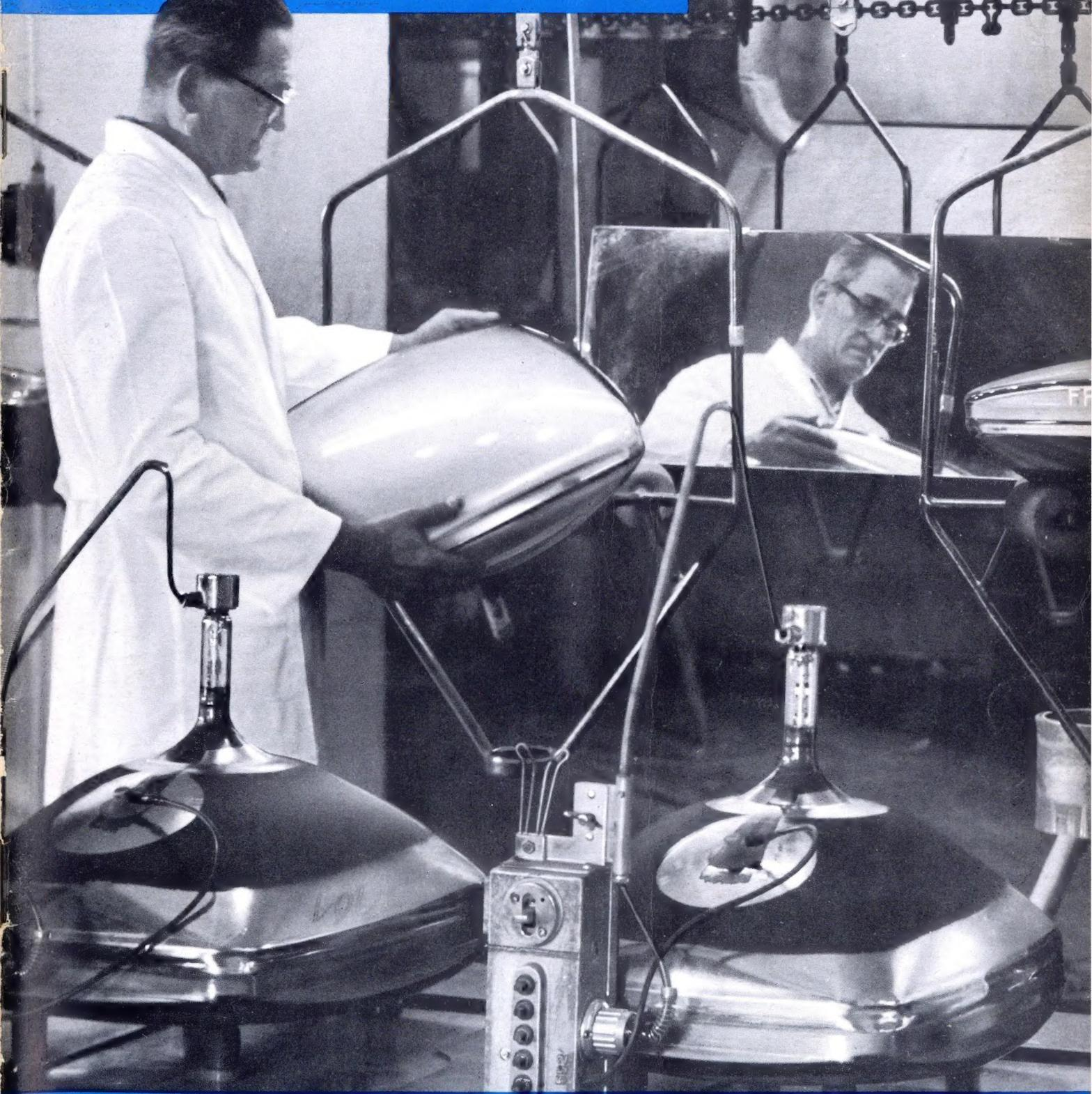
Schirm- und Hochspannungsprüfung von Bildröhren während des Fertigungs-ganges am laufenden Band im Telefunken-Bildröhrenwerk
